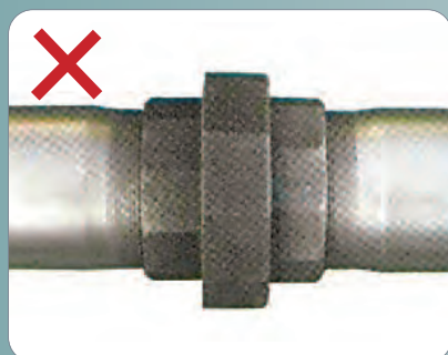
▲UNION 螺纹施工法
