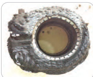
▲ 实验后的内部构造, 完全没受火焰影响的本产品
