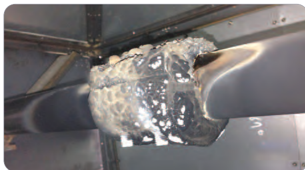
▲ 800℃ 以上温度维持正常压力后实验结束本产品
