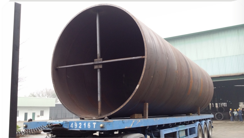
大桩管 & 底通 /Large pipe pile bottom through & amp
