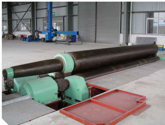
卷板机/Plate bending rolls 型号: CDW11NC-25 X6000 功率: 245MPa
